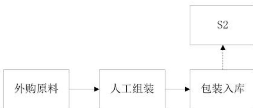
**图 3-3 热封机组装工艺流程图**
