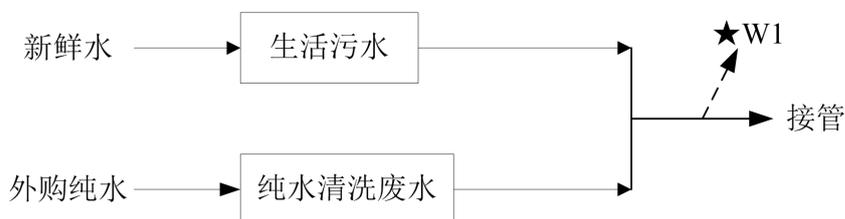
图4-1 废水处理及排放流程（附“★”废水监测点位示意图）
